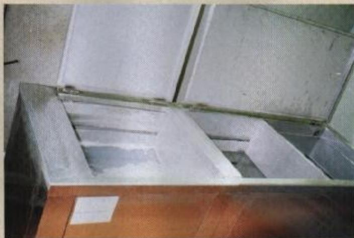
**Impianto di lavaggio e manutenzione ultrasuoni® per stampi per pressofusione di zama, alluminio, zinco, plastica, gomma e poliuretani.**
